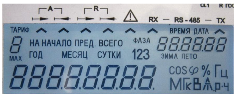
Рисунок 5 – Внешний вид ЖКИ с включенными элементами индикации
