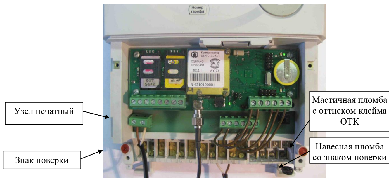
Рисунок 2 - Внешний вид отсека для установки дополнительных интерфейсных модулей
